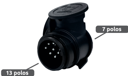
FA200718-B Adaptador compacto 12 V Clavija 13 polos (ISO 11446) a base 7 polos Tipo N (ISO 1724)
